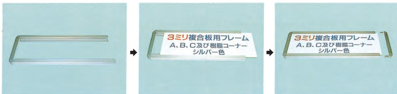
Cフレーム2本とAフレーム1本を組み合わせてコの字を作り、Cフレームのつばに穴を開け壁面に取り付ける。
